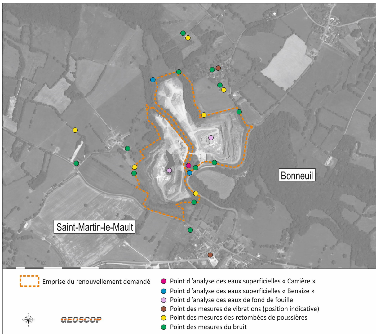
Figure 145 - Ensemble des réseaux de contrôle
